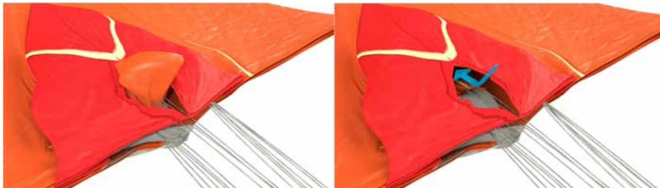
Picture 13 - キャンピアーの頂点部分がはみ出た状態 Picture 14 - キャンピアーの頂点部分を直し、センターラインを中心にする
